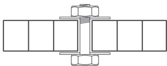
При креплении панелей винтовым соединением или саморезом диаметр отверстия должен быть на 2 мм больше диаметра винта или самореза.
