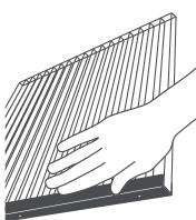
Нижний торец следует закрывать перфорированной лентой, защищающей соты от попадания грязи и пыли.
